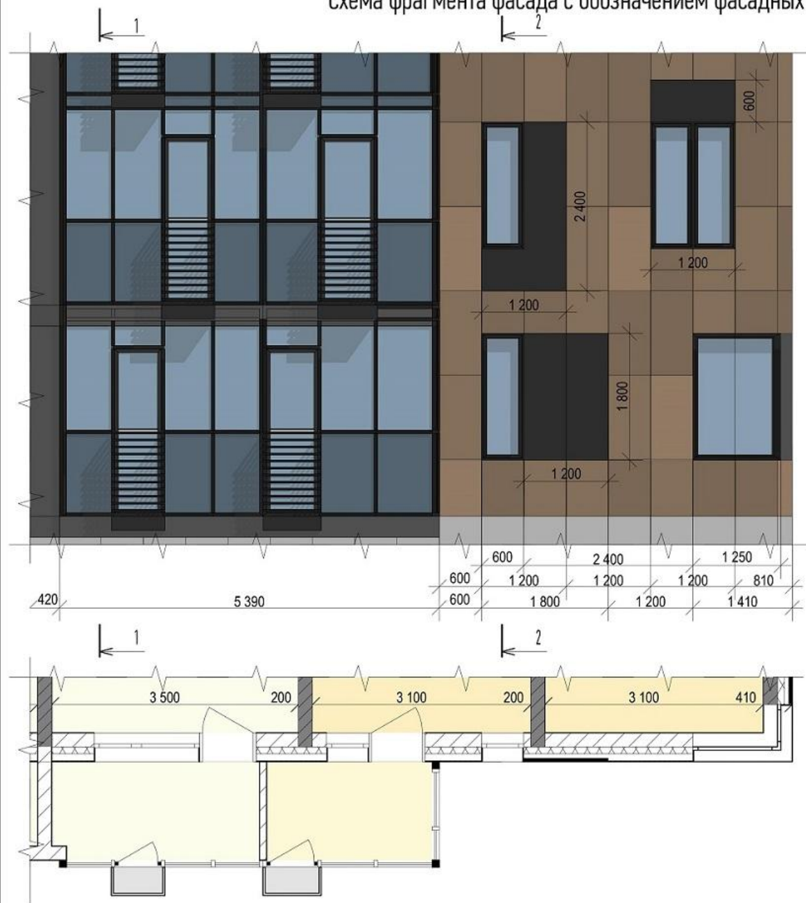
Схема фрагмента фасада с обозначением фасадных конструкций и применяемых отделочных материалов. М1:50
